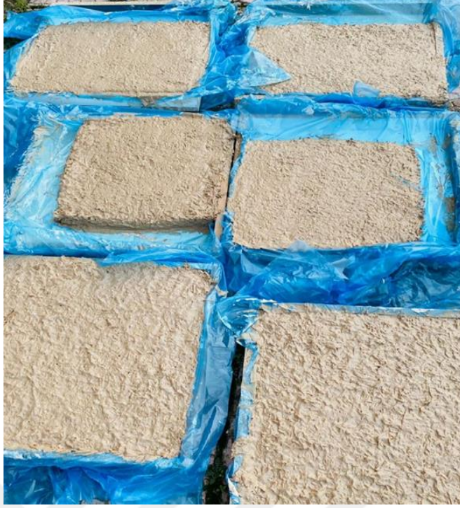
Şekil 3.9. Killi toprak, kireç, çimento ve %35 oranında kenevir kıtığı karışımı
