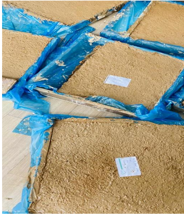
Şekil 3.11. Killi toprak, kireç, çimento ve %15 oranında kenevir kütüğü karışımı
