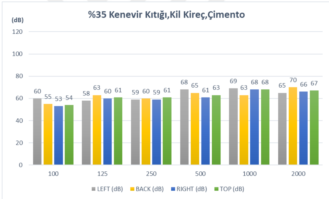
Şekil 3.27. %35 kenevir kütüğü, killi toprak, kireç ve çimento malzemesine ait sabit sıcaklıkta 4 farklı yüzeyde desibel ölçümleri
