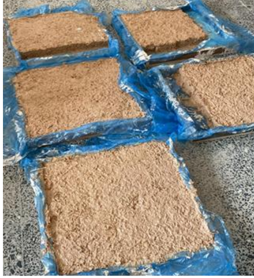
Şekil 3.6. Killi toprak, kireç ve %35 oranında kenevir kıtığı karışımı
