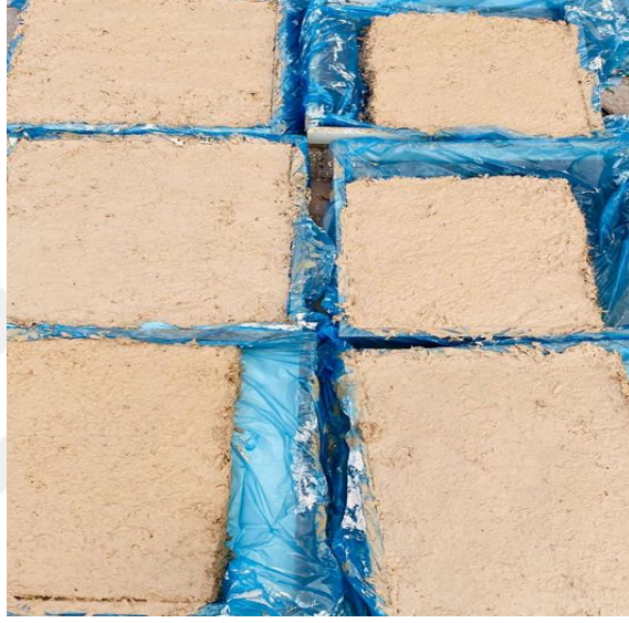
Őekil 3.8. Killi toprak, kire ve %15 oranında kenevir kitiđı karıřımı
