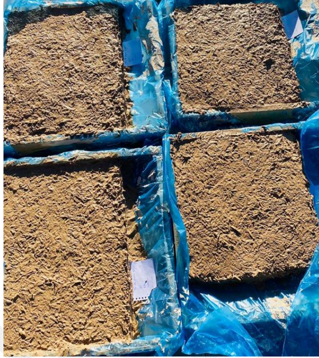
Şekil 3.10. Killi toprak, kireç, çimento ve %25 oranında kenevir kütüğü karışımı
