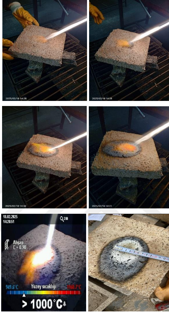
Şekil 3.42. %35 oranlı kenevir kıtığı, kil, kireç ve çimento karışımı levhanın tek noktadan yanma deneyi
