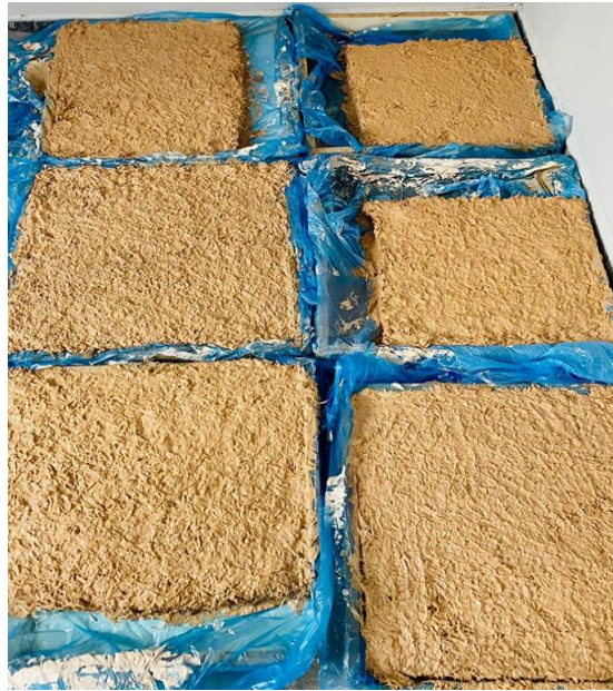
Şekil 3.7. Killi toprak, kireç ve %25 oranında kenevir kıtığı karışımı
