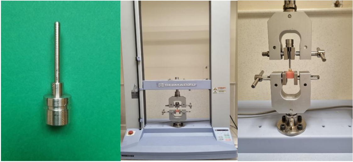
Şekil 17. 4 mm çaplı çelik küresel uç, Universal test cihazı (Shimadzu, Tokyo, Japan)
