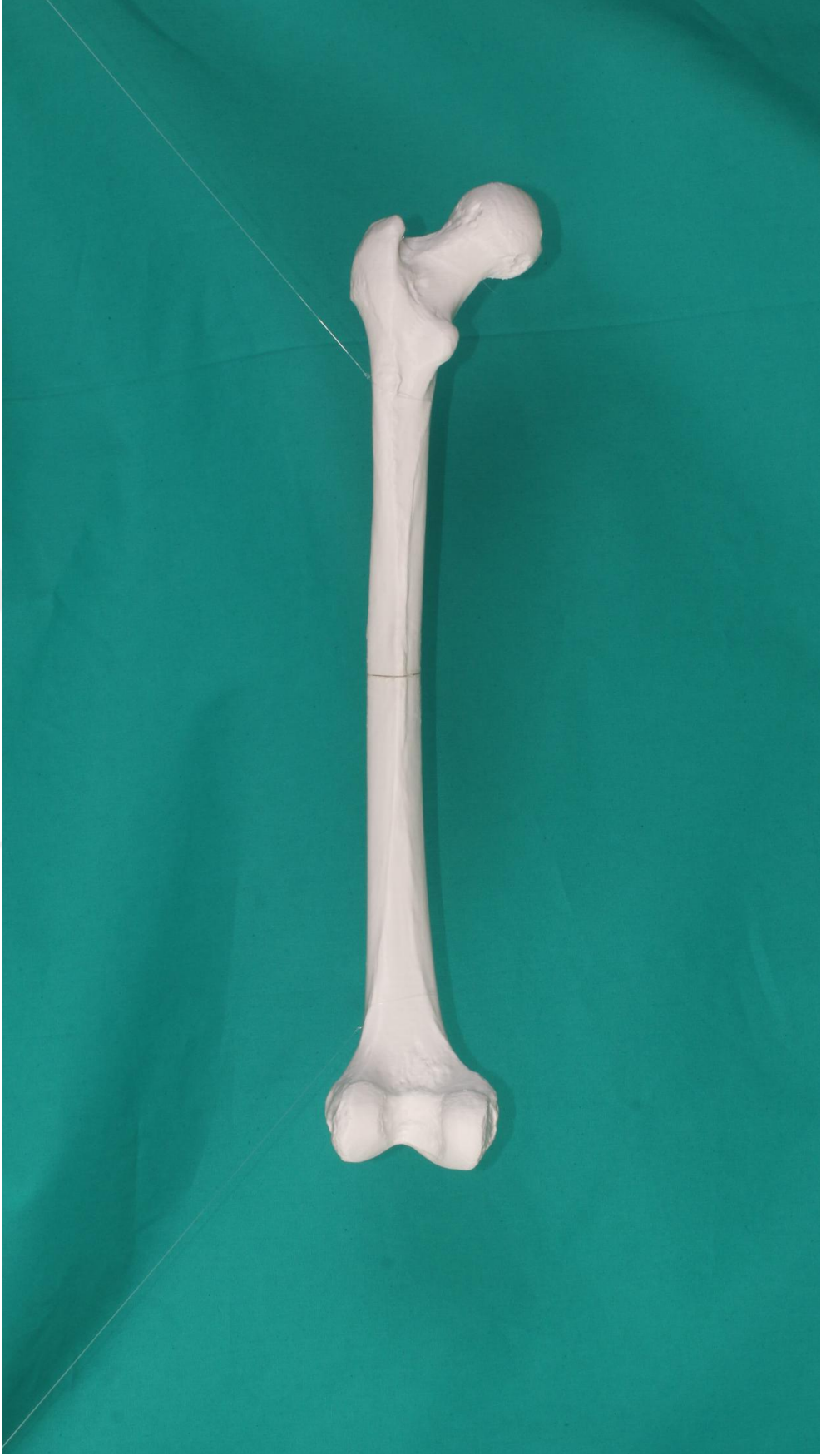
Şekil 3.9. Çıktı alınan üç boyutlu modeller, model D: Eric Bauer tarafından üretilen femur modeli arkadan görünüm.
