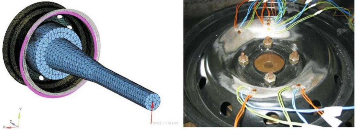
Şekil 45. Viraj Testinin Nümerik Olarak Modellenmesi ve Gerinim Ölçer Yardımıyla Ölçümlerinin Yapılması [51].
