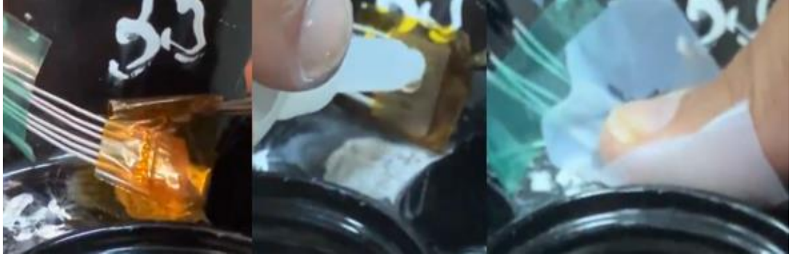
Şekil 49. Gerinim Ölçer için Yüzeye Yapıştırma Çalışması
