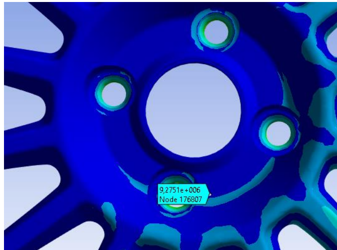
Şekil 79. 2. Gerinim Ölçer Bölgesi için 1500 dev/dak ve 2200 Nm Değerinde Nümerik Analiz Sonuçları
