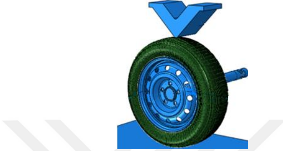
Şekil 12. 90° Darbe Test Görseli [41]
