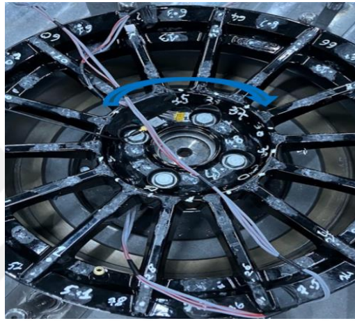
Şekil 77. Jant Konumunun Döndürülerek Değiştirilmesi
