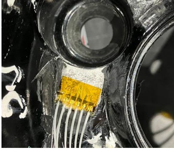
Şekil 52. Üst Yüzeye Yapıştırılmış Olan Gerinim Ölçer Uygulaması
