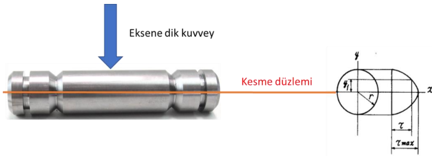
Şekil 2.3 : Çentik kesme gerilme profili gösterimi
