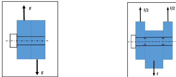
Şekil 2.2 : Tekli Kesme Ve Çift Kesme Düzlemlili Pim Kuvvet Gösterimi
