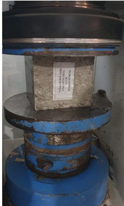
Şekil 3.17. Betonun pres makinesi ile kırımı
