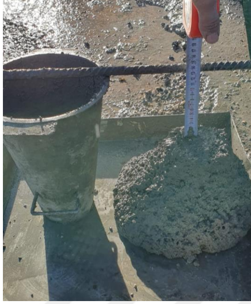
Şekil 3.15. Slump değeri ölçümü
