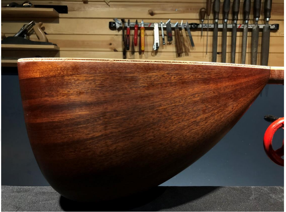
Fotoğraf 20. Sandviç tablanın bağlamaya montajı.
