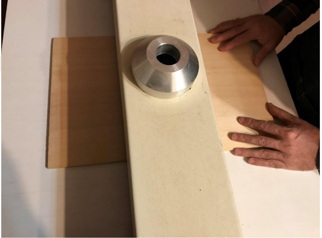
Fotoğraf 6.Ses tablalarının kalibre makinasında inceltilmesi.
