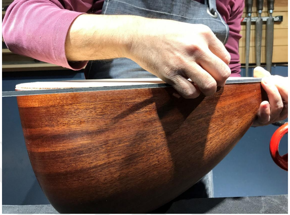
Fotoğraf 21.Sandviç tablanın bağlamaya montajı.
