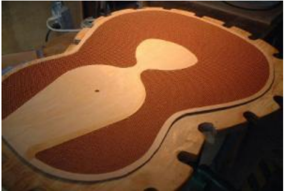
Fotoğraf 4.Gitar ses tablasına kevlar montajı.
