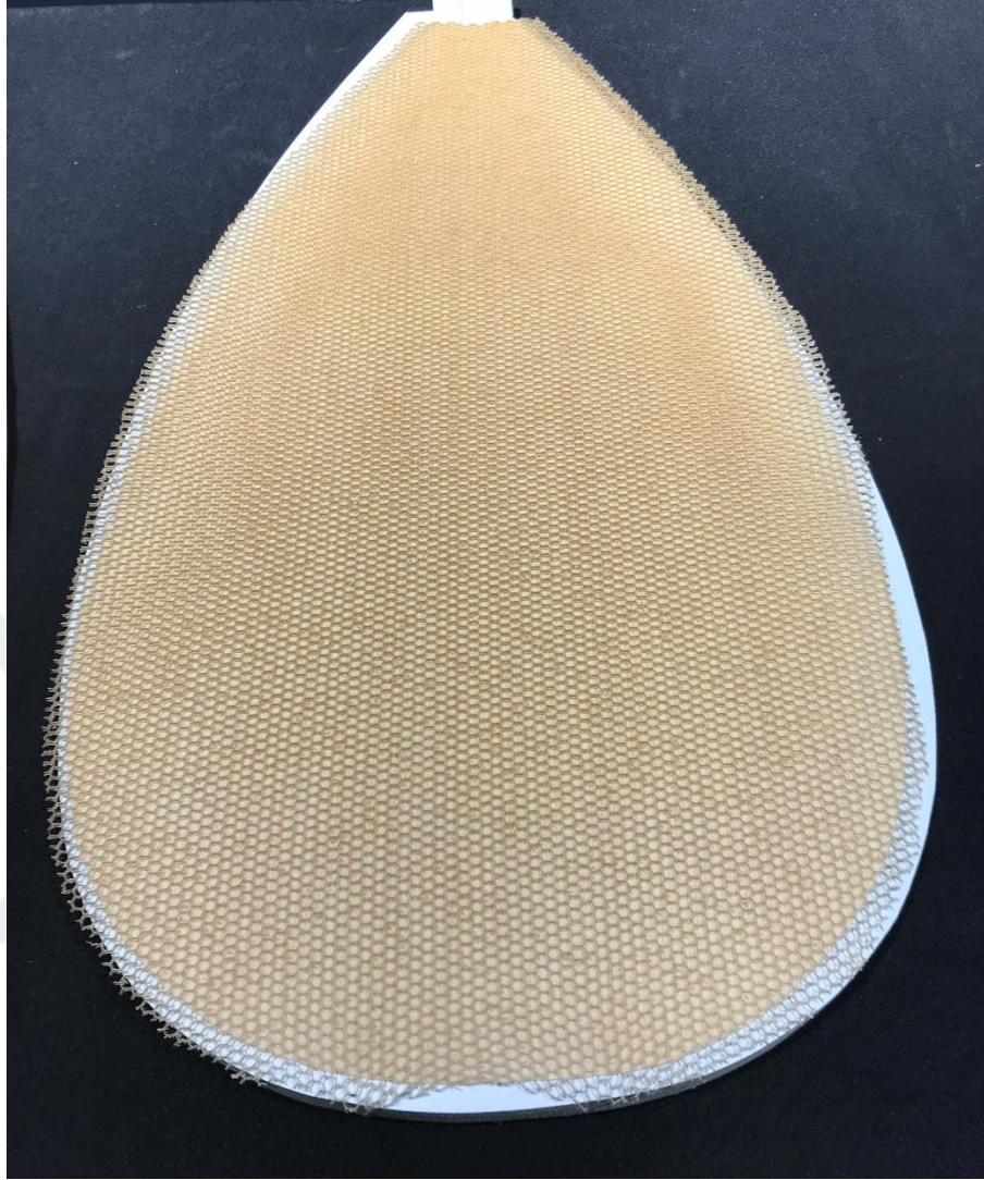
Fotoğraf 16.Kevların ses tablasına montajı.
