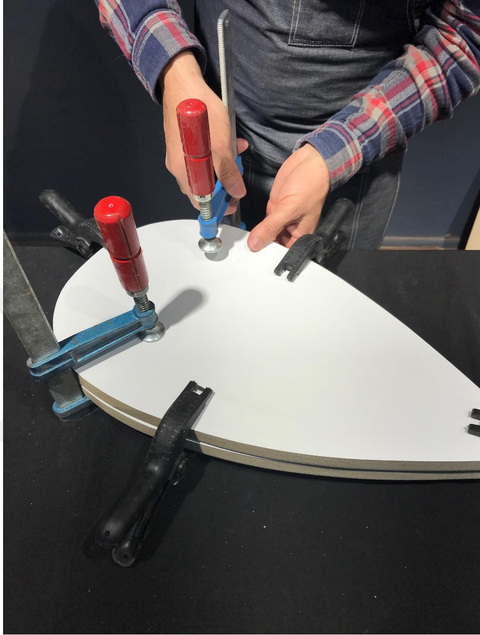
Fotoğraf 19.Kevların ses tablasına montajı.
