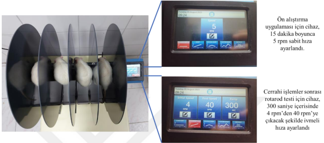
Şekil 3.3. Rotarod cihazının ayarlanması ve hayvanların yerleştirilmesi
