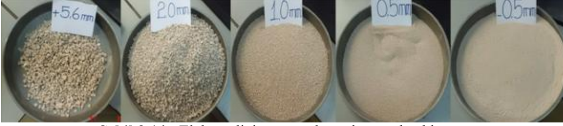
Şekil 3.14 : Elek analizi sonrası duvar kerosu kırıkları.
