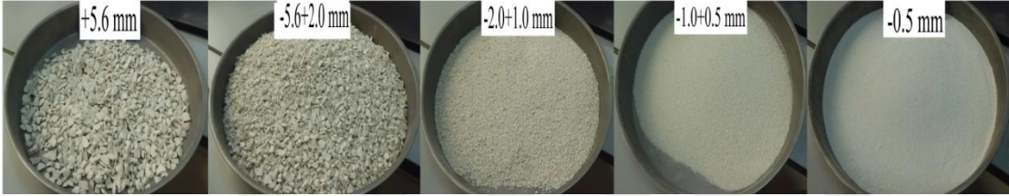
Şekil 3.16 : Elek analizi sonrası granit kırıkları.
