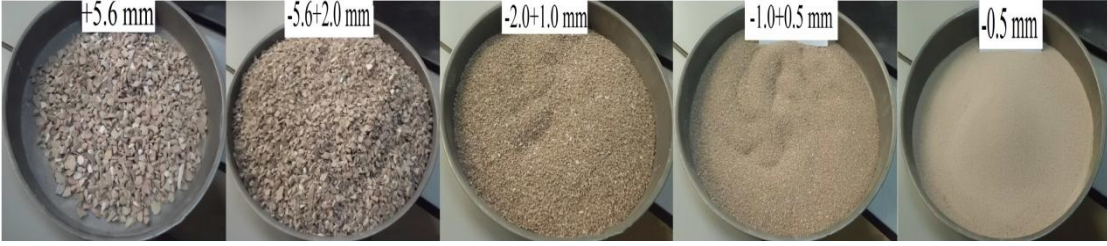
Şekil 3.15 : Elek analizi sonrası yer kerosu kırıkları.
