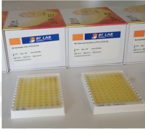
Şekil 9. Renksiz olan substratın sitokinlerin konsantrasyonu ile doğru orantılı olarak oluşturduğu renk değişimi
