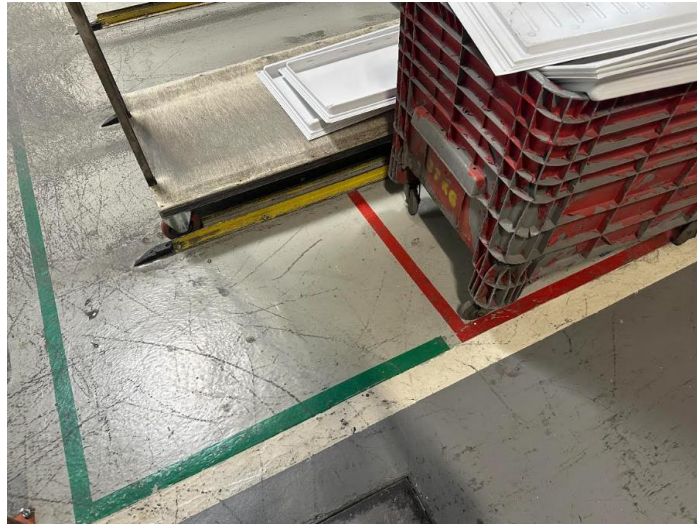
Şekil 5.22 : Alanda hurda olacak iç kapılar ve düzensizce atılmış iç kapılar.
