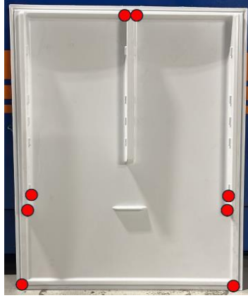
Şekil 5.6 : Soğutucu iç kapıda delik açılan noktalar.
