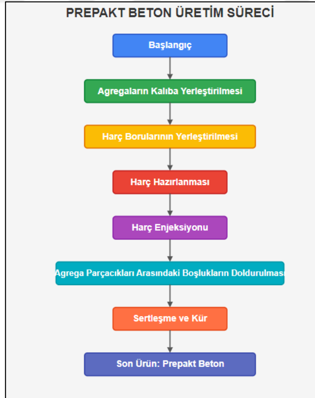
Şekil 1. Prepakt beton üretim süreci
