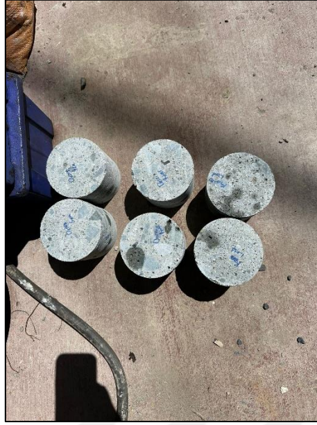
Şekil 9. Karot dayanımı ölçümü için başlıklama için hazırlanmış karot numuneler
