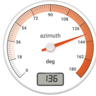
Şekil 3.73: Radial gauge bileşeninin sistem çalışması sırasında gösterdiği azimut değeri örneği
