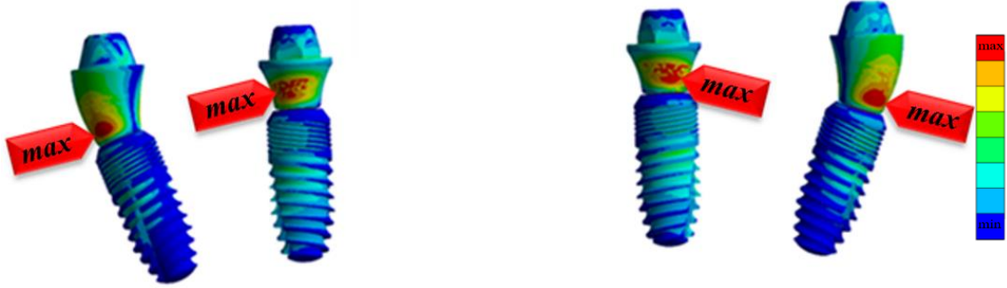
Şekil 4.1. İmplantta meydana gelen Von Mises stres dağılımı
