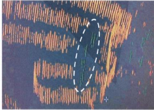
Şekil 2.3 Rüzgar türbinleri sebebiyle radarda yaşanan hassasiyet kaybı [1].
