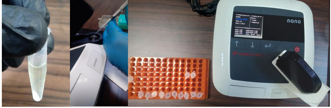
Şekil 3.25. Spektrofotometrik yöntemi ile DNA'nın kalite analizi
