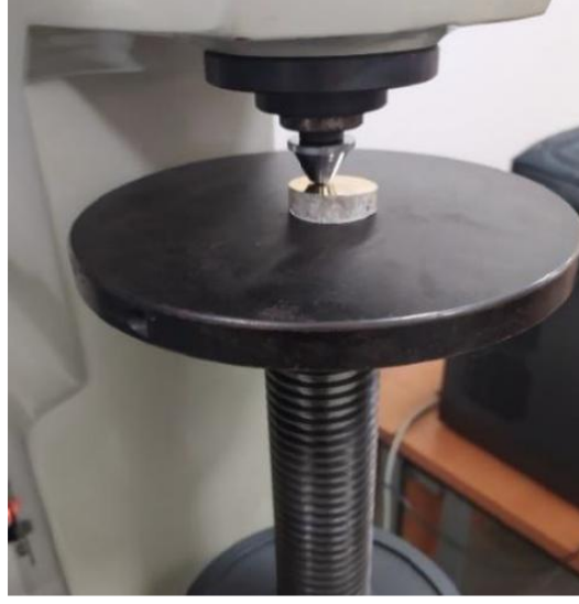
Şekil 4. 5. Brinell sertlik ölçüm prosedürü.
