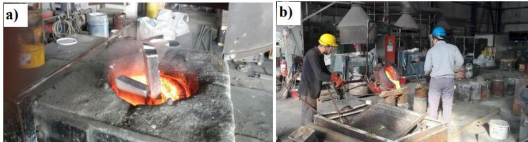
Şekil 4. 1. Döküm işlemlerinde kullanılacak külçelerin hazırlanması: a) Ergitme işlemi, b) Döküm işlemi.
