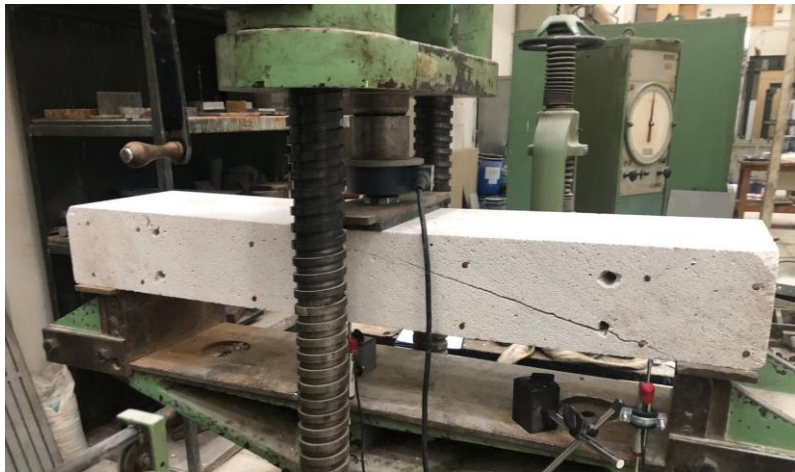
Şekil 3.24 : PDG panel eşdeğer statik üç noktalı eğilme deneyi hasar durumu.
