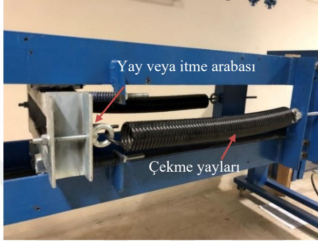
Şekil 2.18 : Yaylı fırlatma sistemi üretimi.
