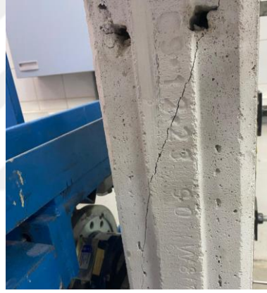
Şekil 3.33 : PDG panel darbe deneyi sonrası aldığı hasar.
