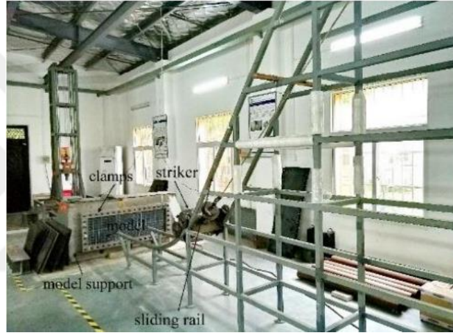
Şekil 1.15 : Wuhan Teknoloji Üniversitesinde bir darbe deney düzeneği
