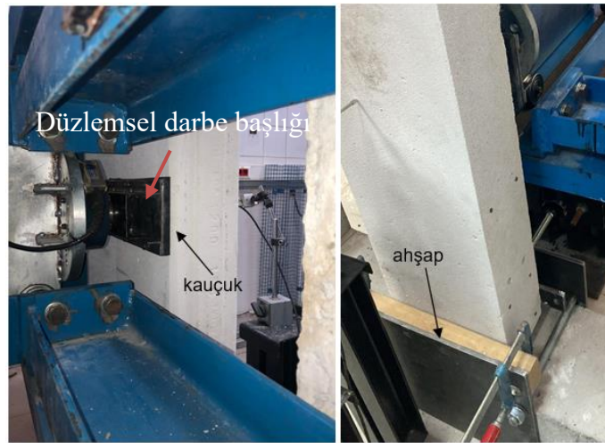
Şekil 3.31 : Donatılı gaz beton panel deneyi darbe başlığı ve mesnet özellikleri.
