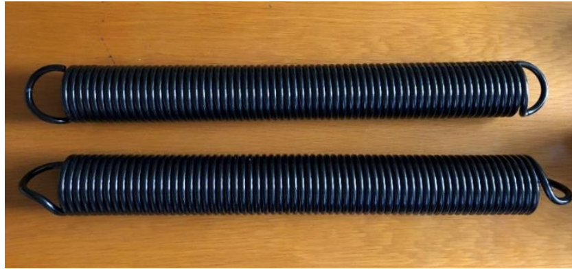
Şekil 2.13 : Tasarlanıp imal edilen yaylar.
