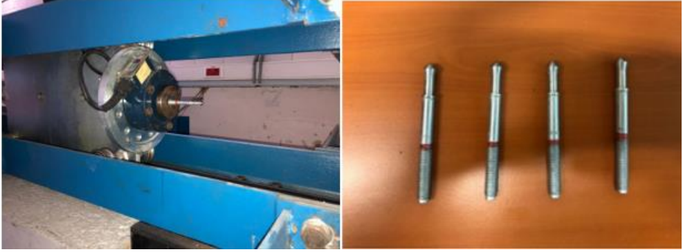
Şekil 3.38 :Penetrasyon deneyleri için darbe başlığı.
