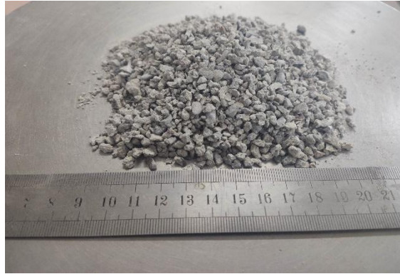
Őekil 3.9 Atık beton agregası (0-5 mm)
