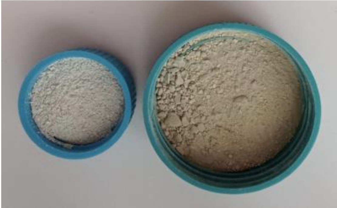
Şekil 4.1. Yeşil sentez öncesi ve sonrası yumurta kabuğu tozunun renk değişimi
