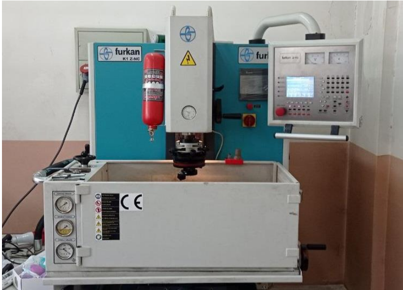
Resim 3.3. Çalışmada kullanılan EEİ tezgahı
