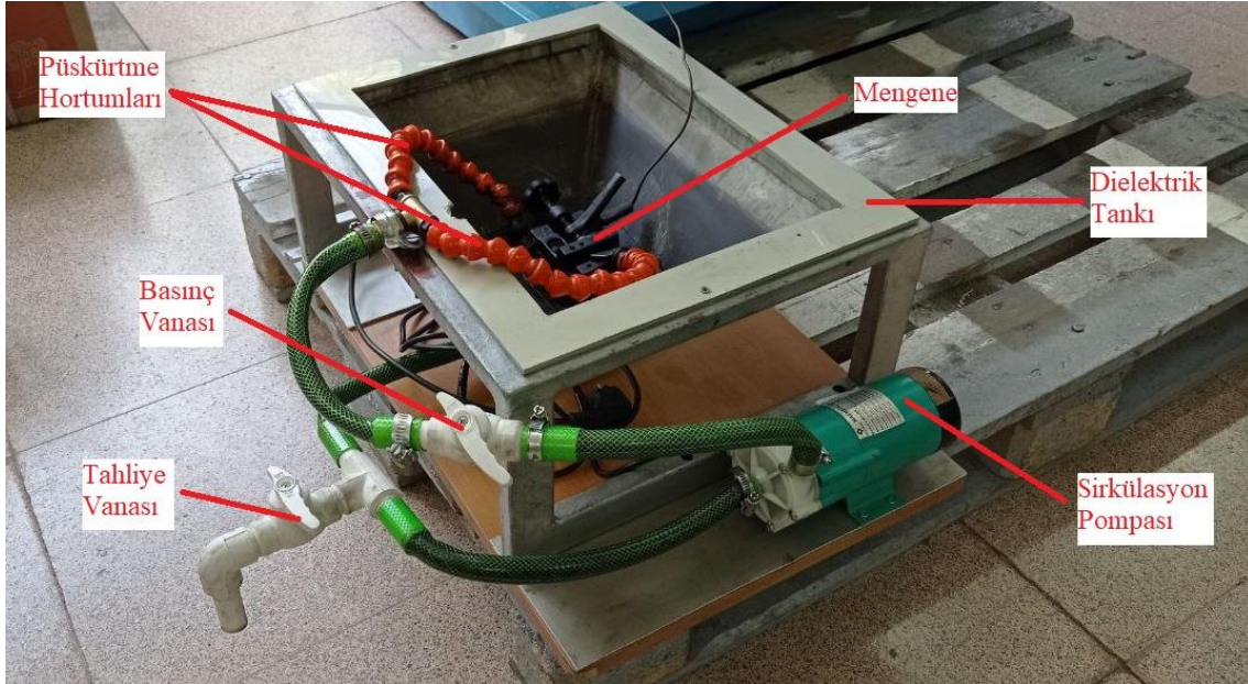
Resim 3.4. Toz karışımı EEİ deney seti
