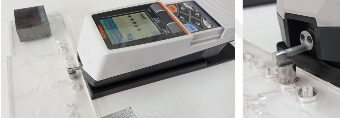
Resim 3.9. Yüzey pürüzlülüğü ölçümü (solda), yakın çekim (sağda)
