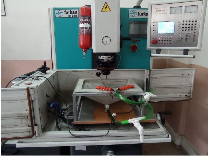
Resim 3.5. Toz karışımı EEİ deney setinin tezgah üzerine yerleştirilmesi
