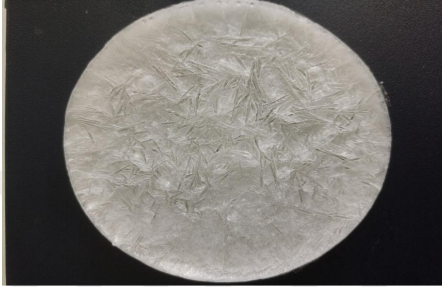
Şekil 4.1. Aljinat-jelatin-kitosan kompozit sünger yapısı (Kontrol).
