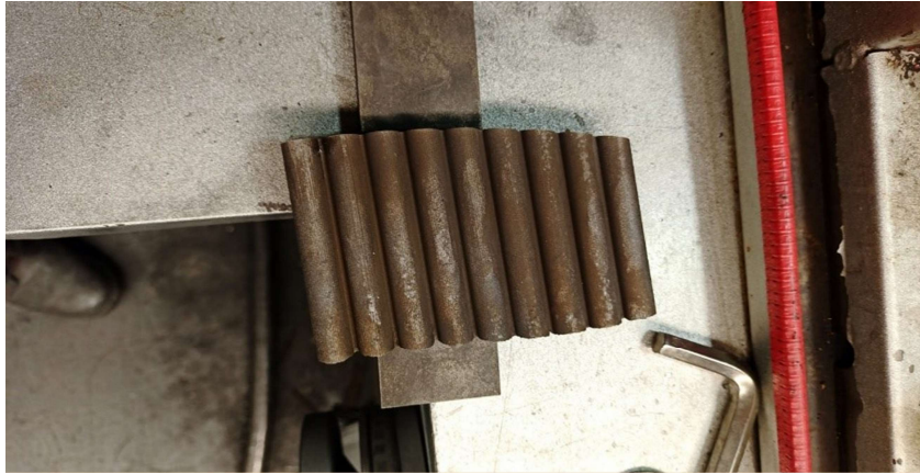
Şekil 4.6: Tel erazyon ile kesilen numuneler
