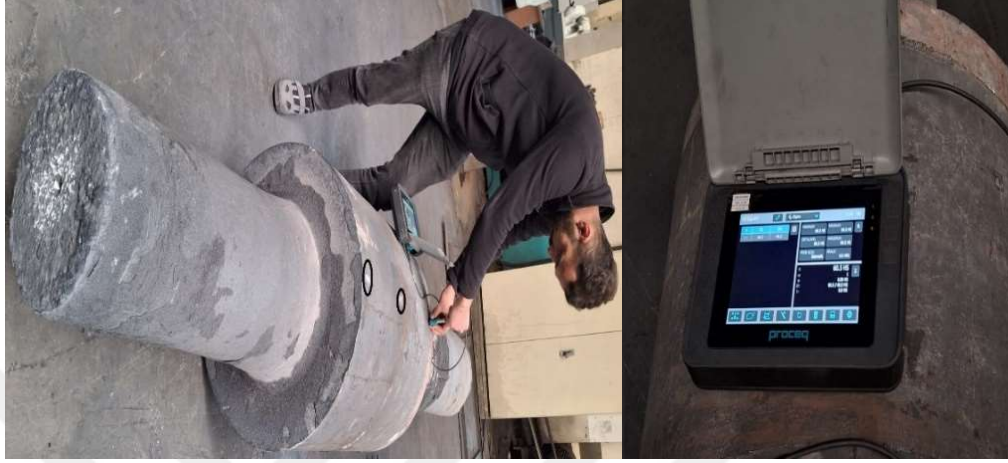
Şekil 4.13: Merdane sertlik ölçümü ve sertlik cihazı
