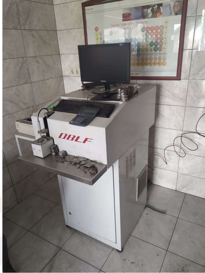
Şekil 4.1: Kimyasal bileşim kontrolü için kullanılan spektrometre cihazı
