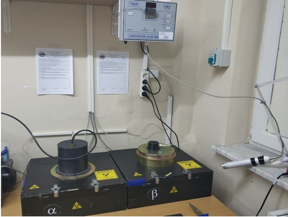
Şekil 3.3 : Sr^{90} - Y^{90} beta ve ^{241}Am_{146} alfa ışınlama kaynakları.
