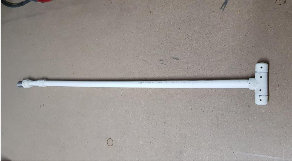
Şekil 5.14. Biyofiltre su giriş sistemi PVC boru (Orijinal).
