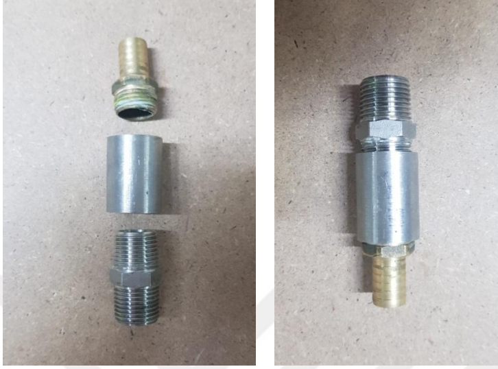
řekil 5.10. Biyofiltre su giriř fittingleri ve montaj (Orijinal).
