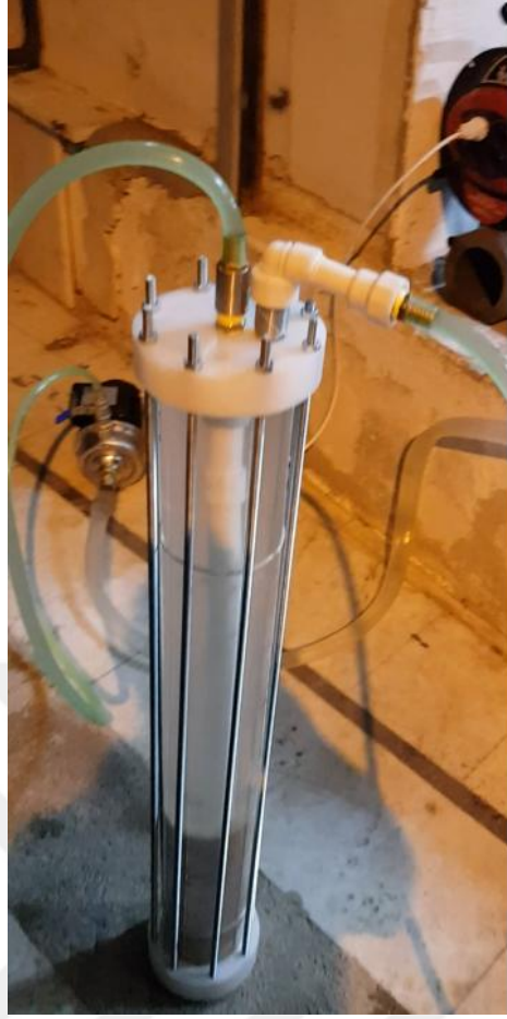
Şekil 5.20. Montajı tamamlanmış biyofiltre (Orijinal).
