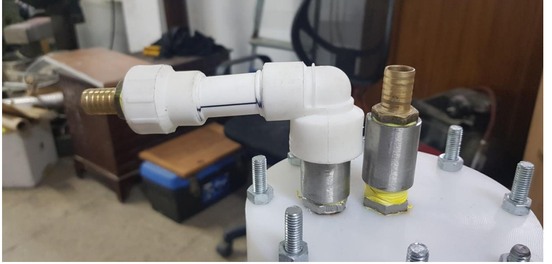
Şekil 5.12. Biyofiltre su girişi fittinglerinin üst kapağa montajı (Orijinal).
