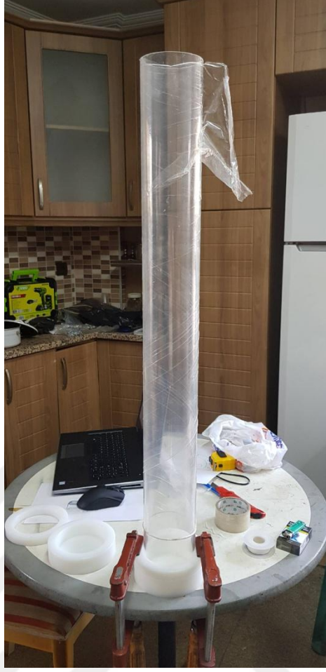
Şekil 5.18. Alt kapağın akrilik boruya montajı (Orijinal).
