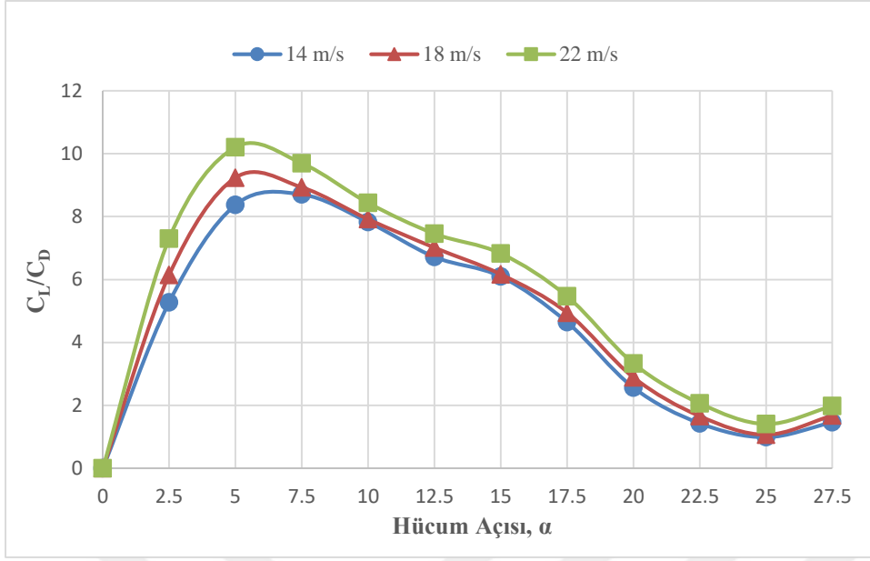
Şekil 6.7. NACA 0015 kanadının farklı hızlarda C_L/C_D değerlerinin karşılaştırılması
