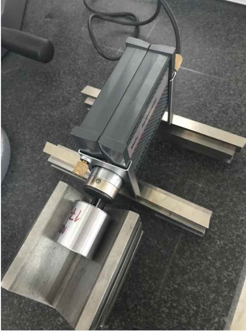
Şekil 4.10. Yüzey pürüzlülük değerinin ölçüm sırasındaki görseli
