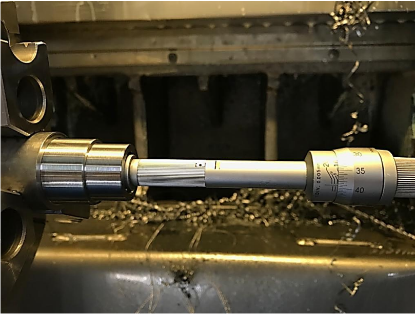
Şekil 4.5. İşlem sonrası iç çap mikrometresi ile ölçüm
