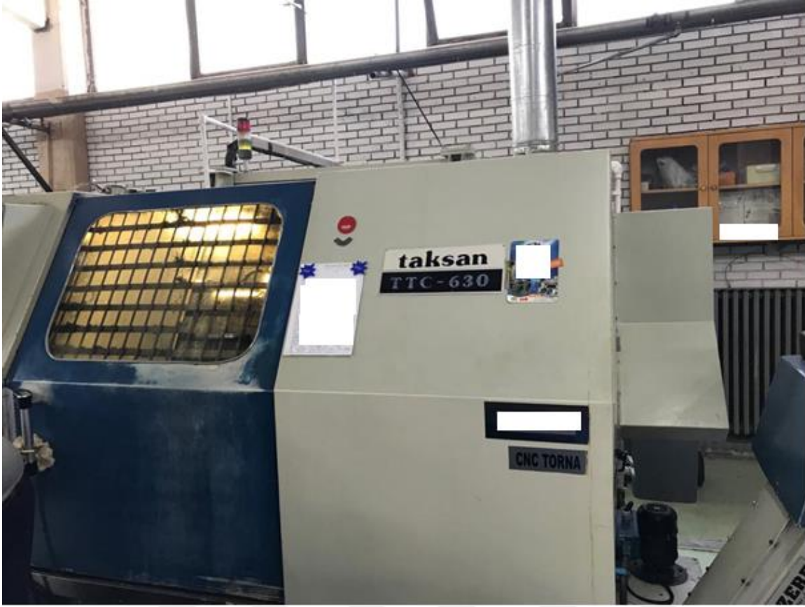
Şekil 4.2. Ön işlemin yapıldığı CNC torna tezgâhı
