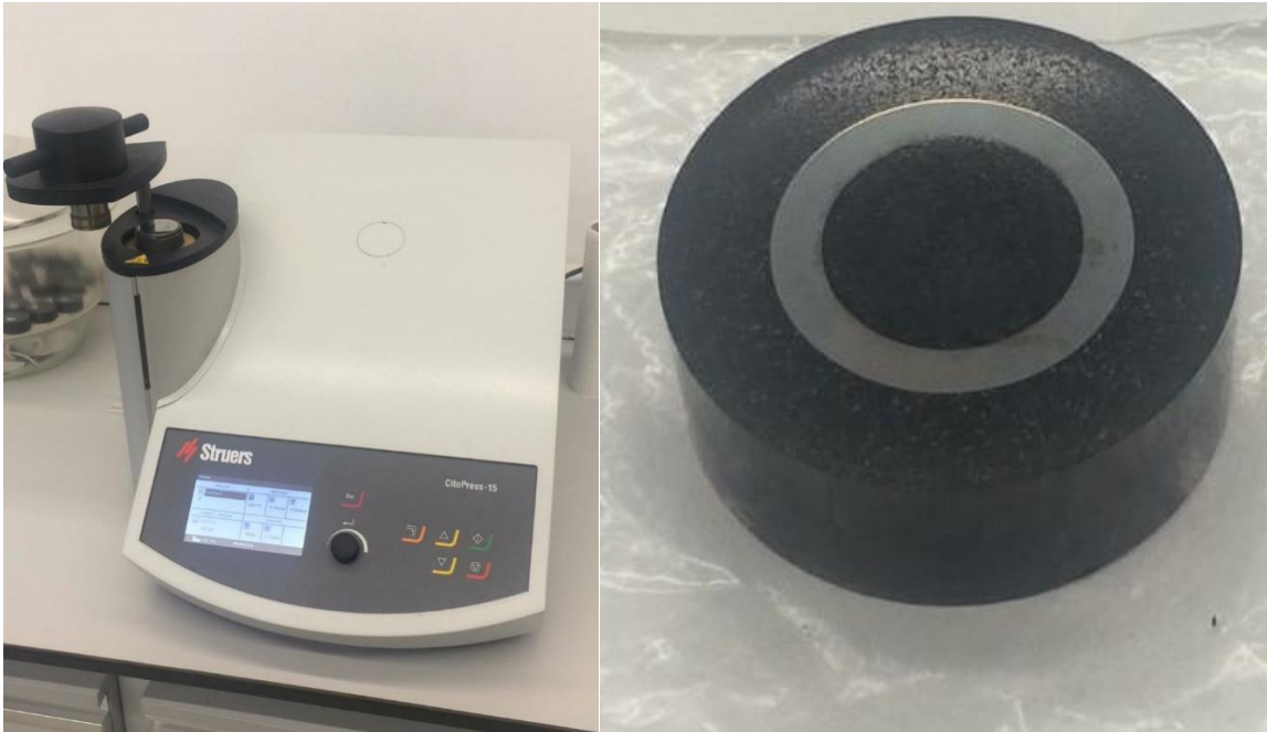
Şekil 4.13. Bakalite alma cihazı ve deney numunesinin bakalite alınmış hali
