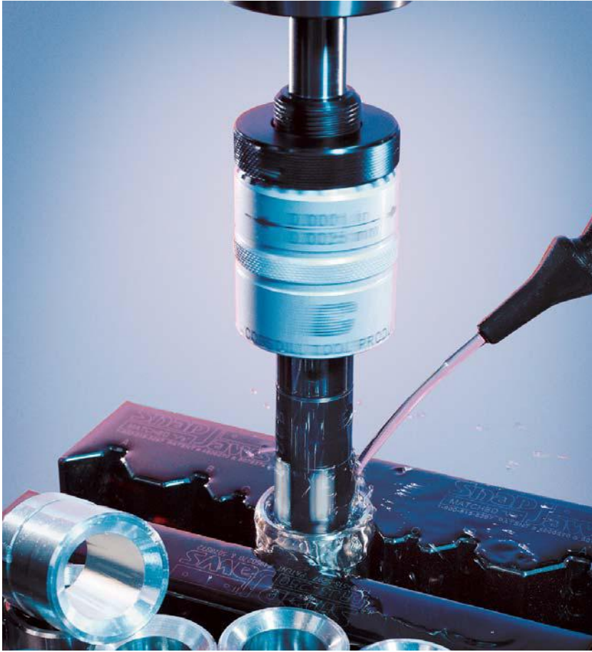
Şekil 2.12. Ezme takımının matkap tezgâhına bağlanma şekli [6]
