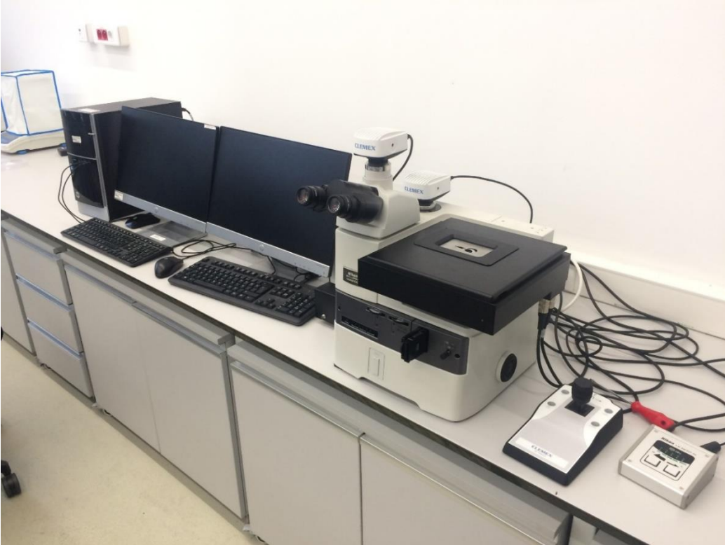
Şekil 4.15. Nikon marka optik mikroskop
