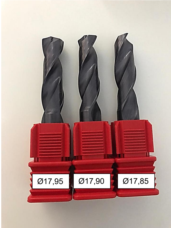
Şekil 4.6. Kesici matkap takımları [43]
