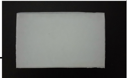
Kalıptan çıkarılan kompozit numune
