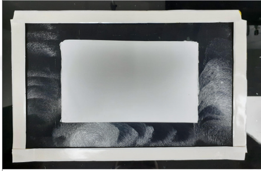
Cam kalıp üzerine yerleştirilen nanoelyaflar
