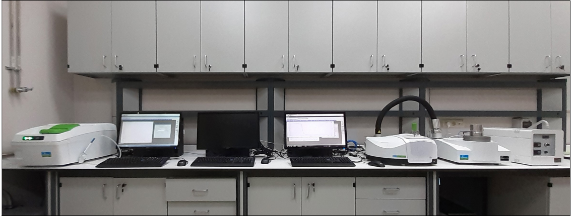
Şekil 3.6. Moleküler ve termal analizlerde kullanılan FTIR, TGA ve DSC cihazları
