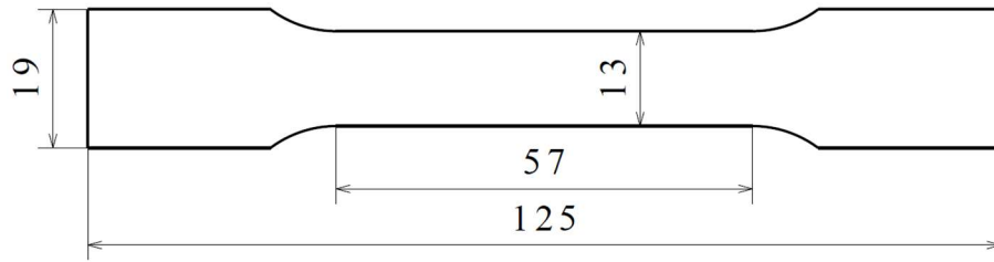
Şekil 3.7. Çekme deneyi numunesi ölçüleri
