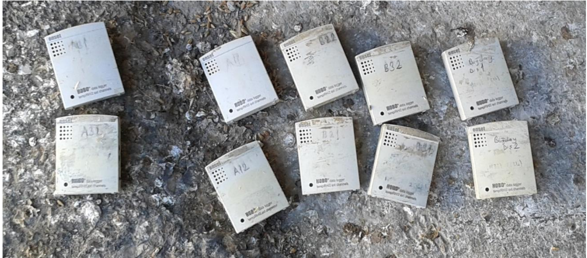
Şekil 3.5. Sıcaklık, Oransal Nem ve Çiğlenme Sıcaklığı Ölçüm Aletleri (HOBO)
