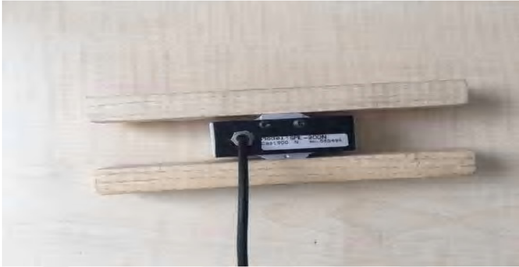
Şekil 51. Maksimum pençe kuvveti ve maksimum pençe kuvveti üretim hızı oranı ölçüm aleti.
