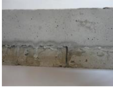
Fotoğraf 4.2. Yansıma çatlak testi sonrası TÇEK/MB kompozitlerinin görüntüleri %1.00PVA-TÇEK/MB (a), %1.25PVA-TÇEK/MB (b), %1.50PVA-TÇEK/MB (c), %1.75PVA-TÇEK/MB (d), %2.00PVA-TÇEK (kontrol karışımı)/MB (e)
