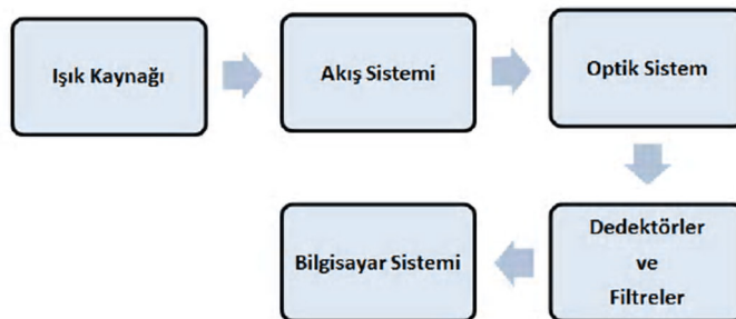
Şekil 2.17. Akım sitometri cihazı temel bileşenleri
