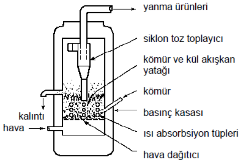
Şekil 4.4: Basınçlandırılmış akışkan yataklı bir fırının şematik görünümü
