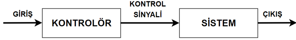
Şekil 3.24. Açık çevrim kontrol sistemi
