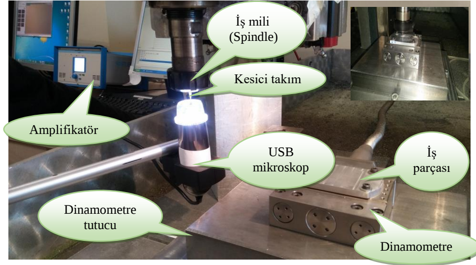
Resim 3. 1 Mikro kesme işleminin gerçekleştirildiği deney düzeneği.
