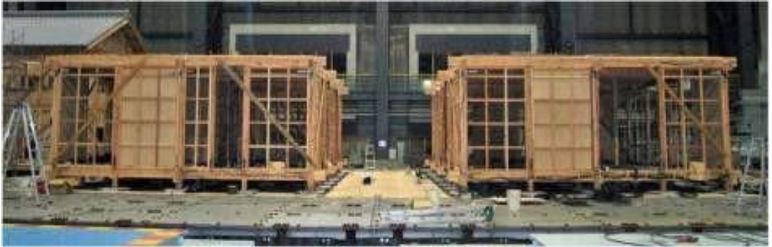
Şekil 3.69. Tam ölçekli E-Defense sarsma masası deneyi
