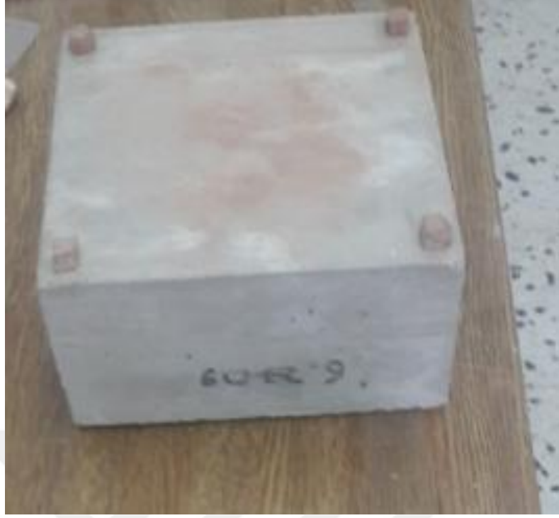
Şekil 3.20. Horasan harcı numuneleri
