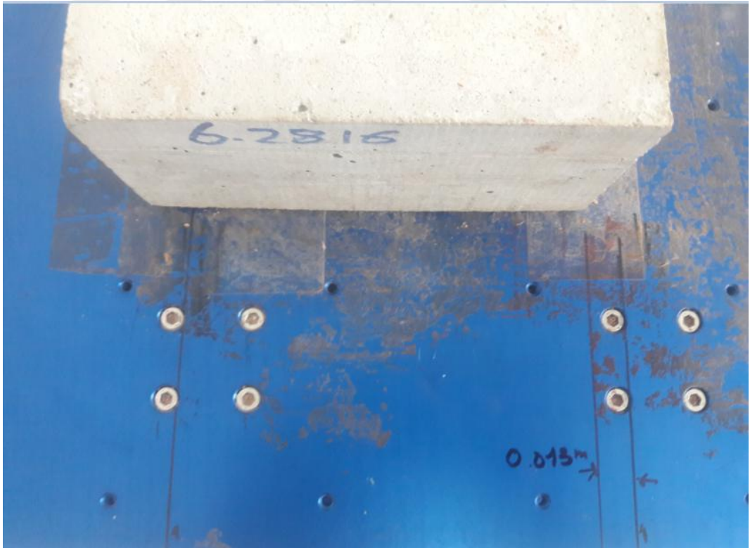
Şekil 3.65. Deney sonrası gözlenen kalıcı yerdeğiştirme
