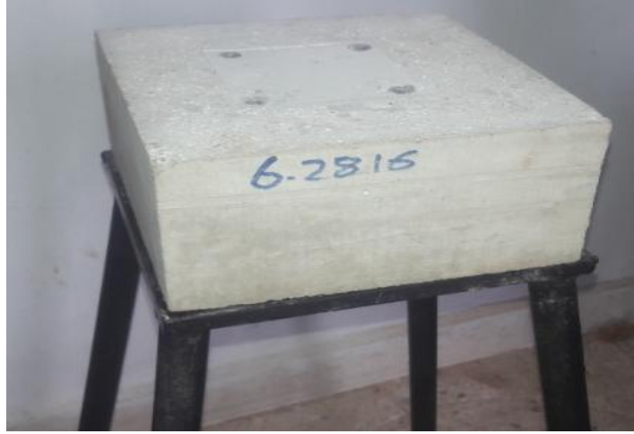
Şekil 3.17. Hazırlanan ölçeklendirilmiş üstyapı modeli
