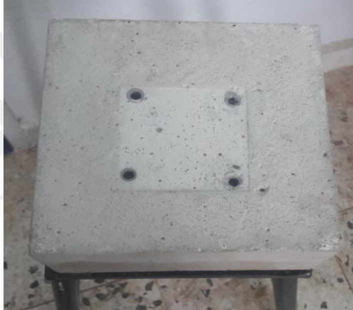
Şekil 3.18. Hazırlanan ölçeklendirilmiş üstyapı modeli
