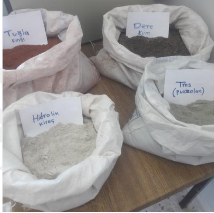
Şekil 3.19. Horasan harcı bileşenleri
