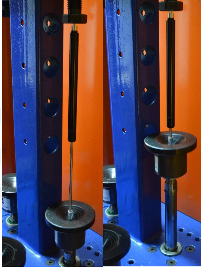
Şekil 2.22. Gazlı amortisör ömür testi cihazı.
