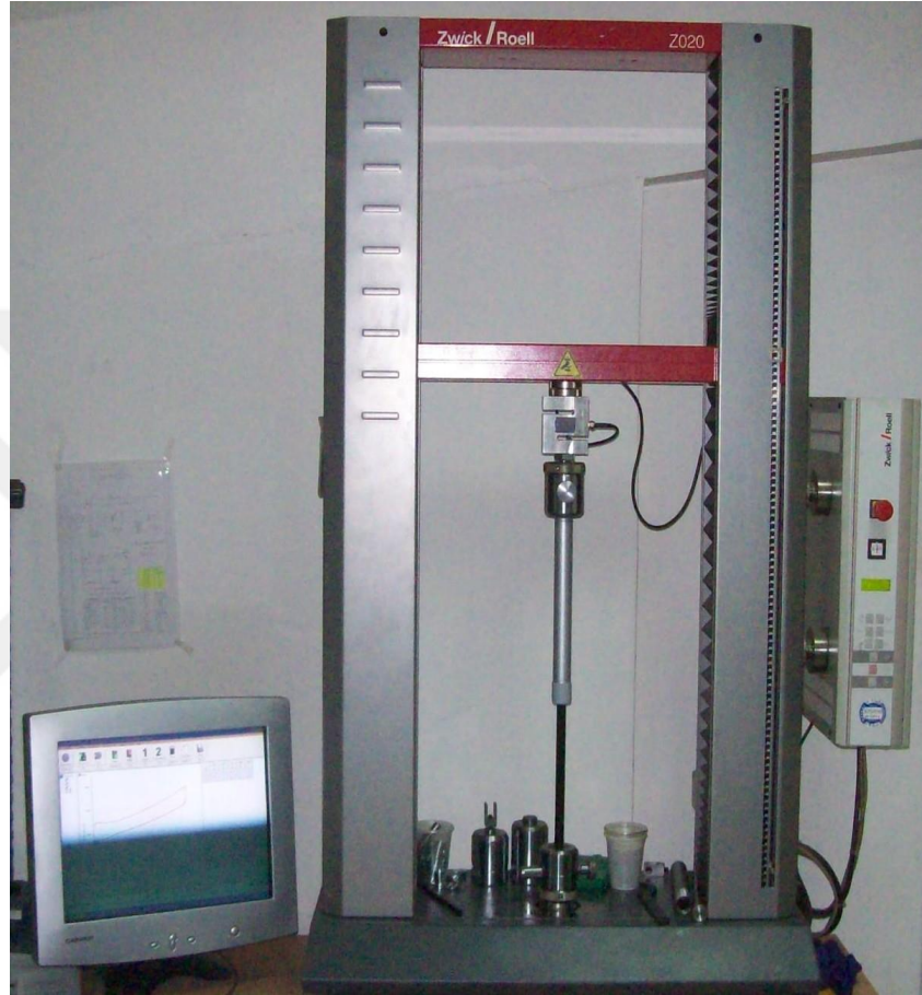
Şekil 2.21. ZWICK FB020 üniversal amortisör kuvvet ölçümü test cihazı.
