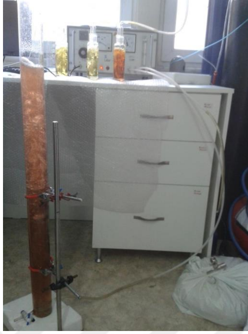
Şekil 3.5: Tekstil atıksuyuna ozonlama işleminin uygulanması
