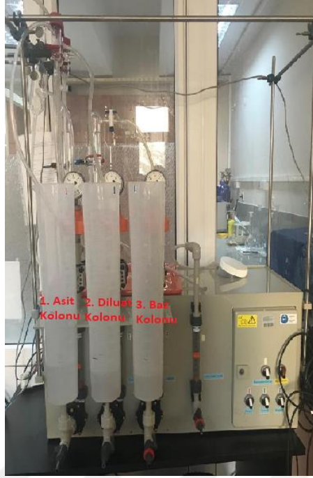
Şekil 3.9: ED sisteminde kullanılan asit, diluat ve baz kolonlarının gösterimi
