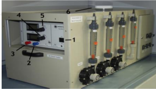
Şekil 3.10: ED sistemine ait güç kaynağı ve pompa sistemi (1-ana şalter, 2-eksi elektrik çıkışı, 3-artı elektrik çıkışı, 4-maksimum amper ayarı için potansiyometre, 5-anolit çıkışı, 6-konsantre girişi)
