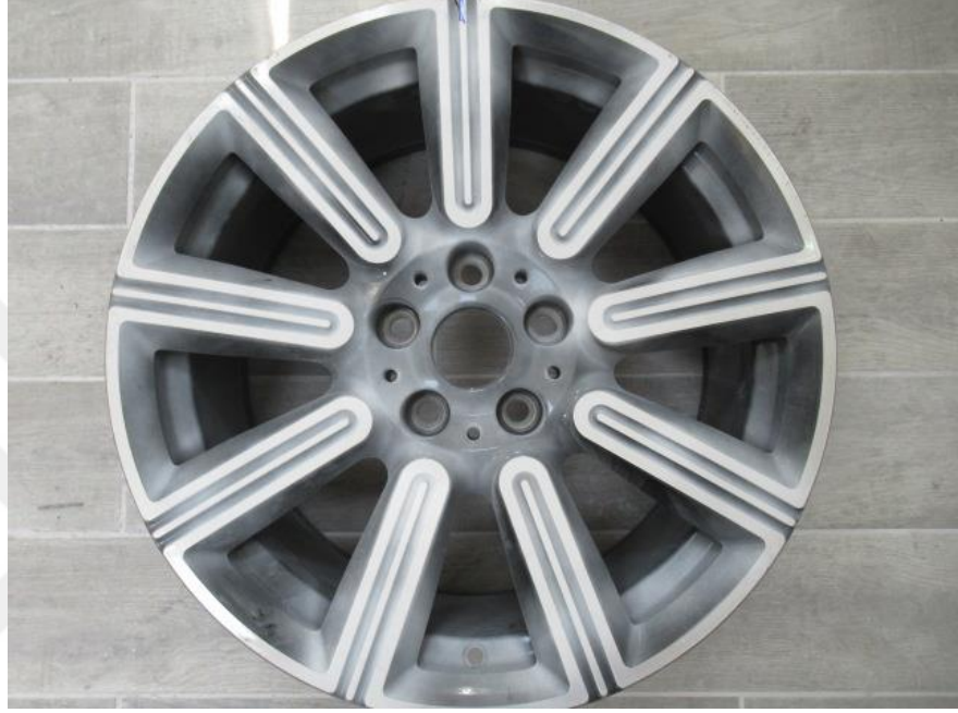
Şekil 5.4. Gerçek darbe testi sonucu ön görünüşü
