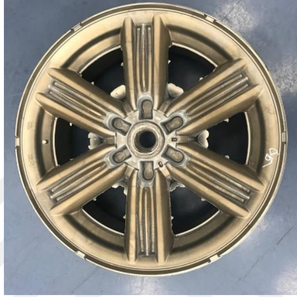
Şekil 2.6. Brüt (Dökülmüş) jant ön görüntüsü
