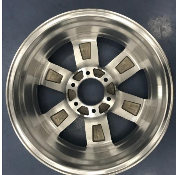
Şekil 2.8. İşlenmiş jant ön görüntüsü
