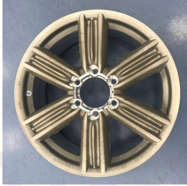
Şekil 2.8. İşlenmiş jant ön görüntüsü
