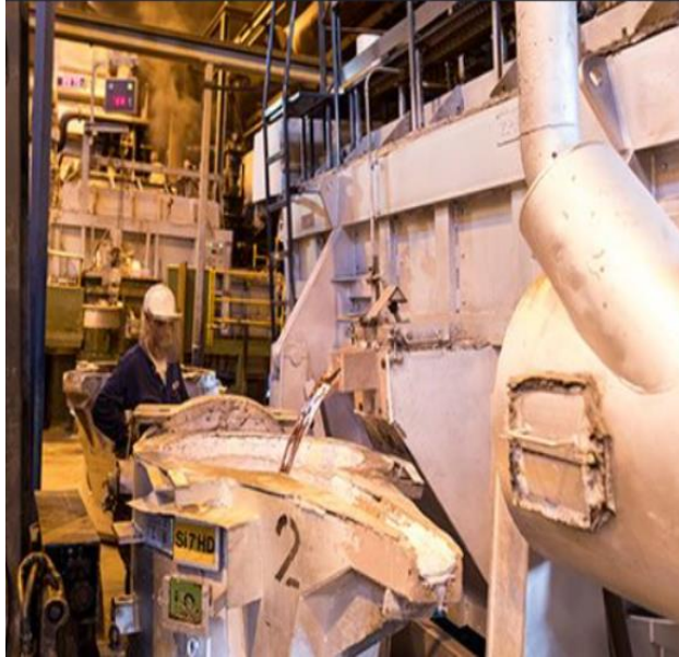
Şekil 2.2.Ergimiş metalin bekletme ocaklarına transferi
