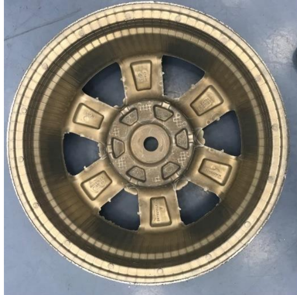
Şekil 2.6. Brüt (Dökülmüş) jant ön görüntüsü
