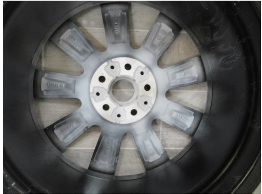
Şekil 5.5. Gerçek darbe testi sonucu arka görünüşü
