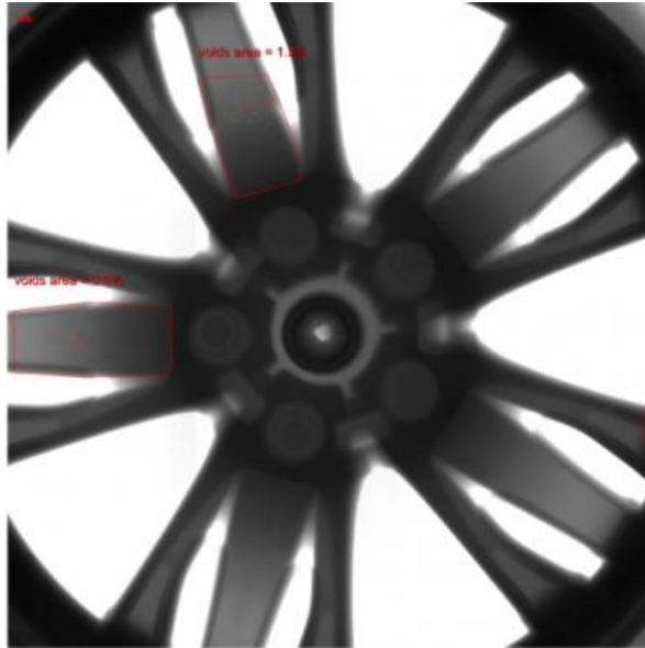
Şekil 2.5. Bir jantın X-Ray kontrol görüntüsü
