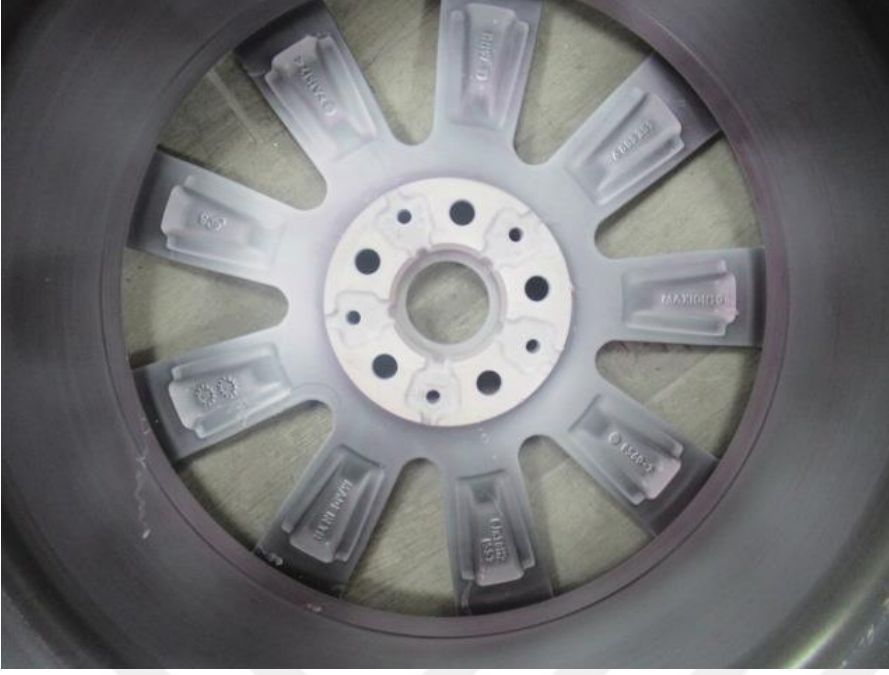
Şekil 5.9. Yüksek ağırlık ile yapılan gerçek darbe testi sonucu arka görünüşü
