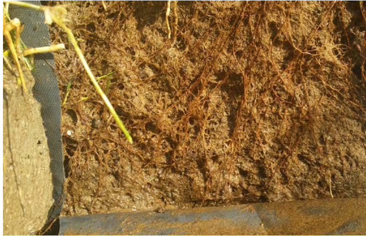
Şekil 4.19. Bariyer olmayan yerdeki kök gelişimi
