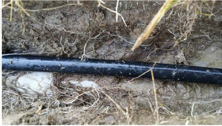
Şekil 4.2. İki yıl kullanılan TADS boruların etrafındaki kök sarmalı
