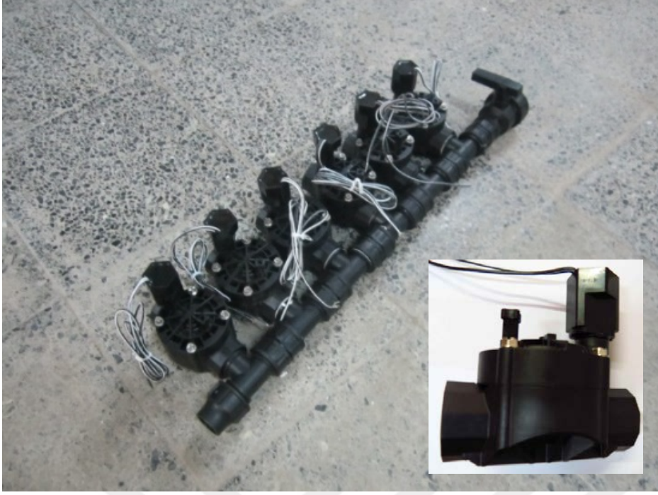
Şekil 3.10. Deneme düzeninde kullanılan 24V AC solenoid vanalar
