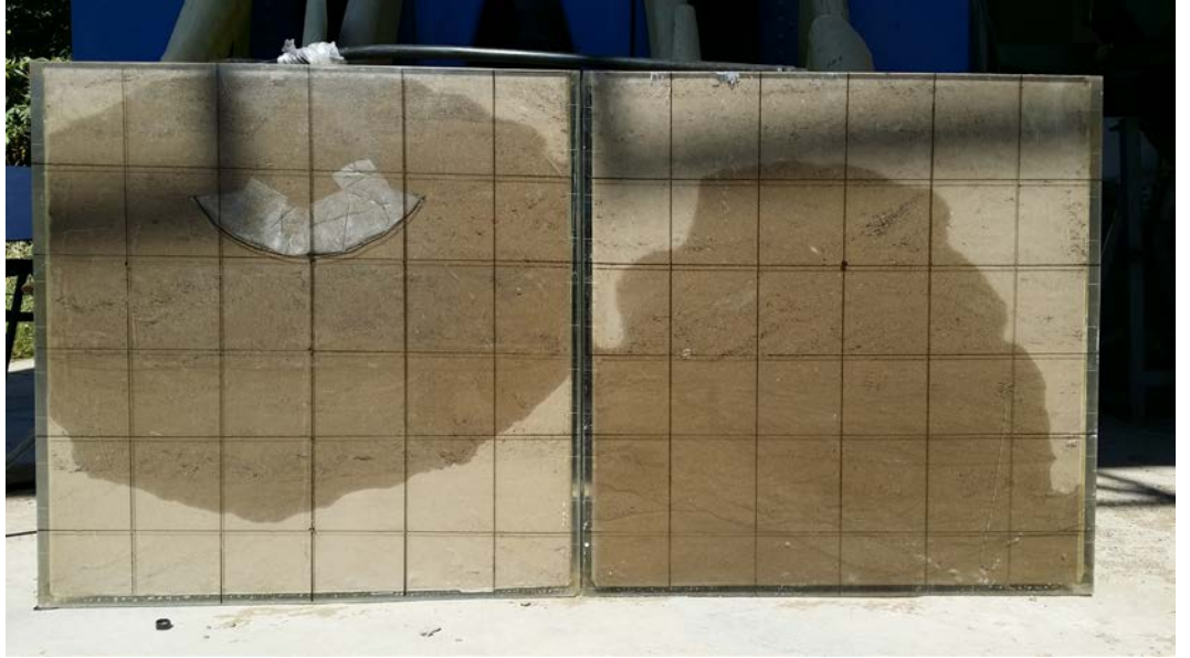
Şekil 4.5. Sulama kesildikten 24 saat sonra suyun bariyerli ve bariyersiz düzenekteki durumu
