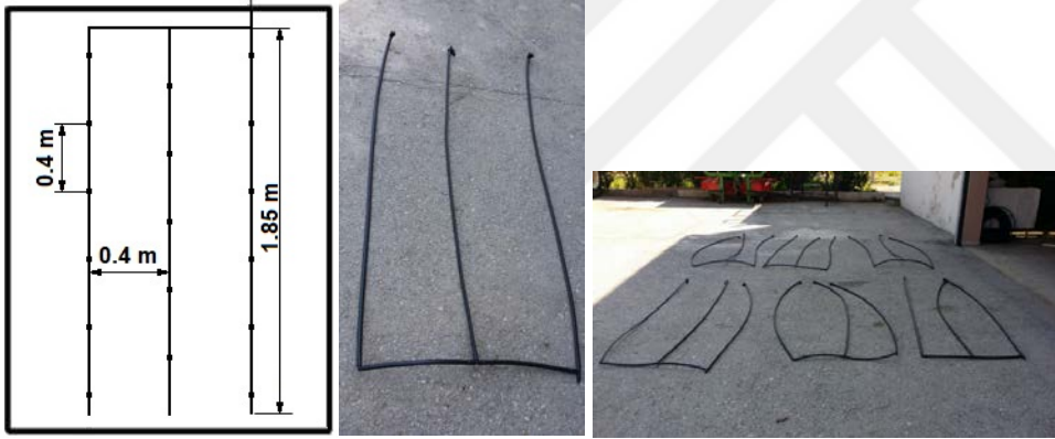
Şekil 3.32. TADS borularının hazırlanması ve ölçüler
