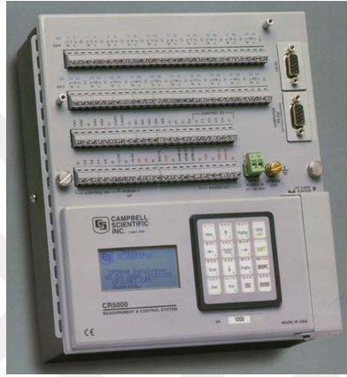
Şekil 3.15. Ölçüm ve kontrol cihazı (CR5000, CAMPBELL Scientific Inc.)
