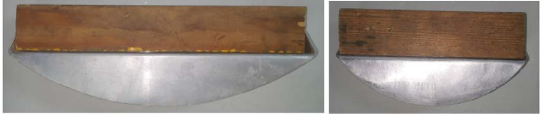
Şekil 3.36. Bariyer yerleştirilecek toprak profilinin düzenlenmesinde kullanılan sürgü
