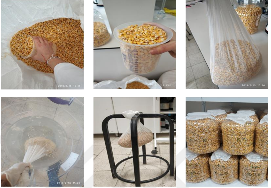
Şekil 3.1. Depolamada kullanılan mısırların farklı konsantrasyonlardaki tuz çözeltilerine farklı sürelerle daldırılma işlemi
