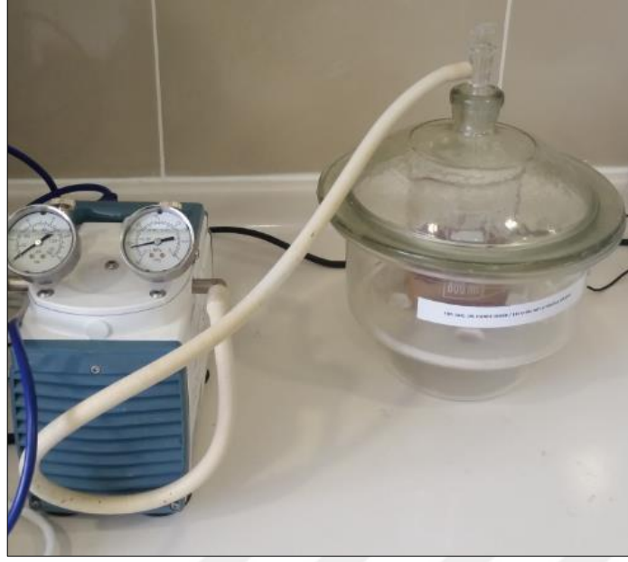
Şekil 3.3 Et dilimine uygulanan vakum emdirme ön işlemi
