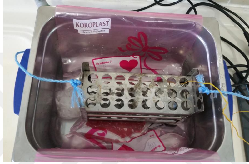
Şekil 3.2 Et dilimine uygulanan ultrasonikasyon ön işlemi
