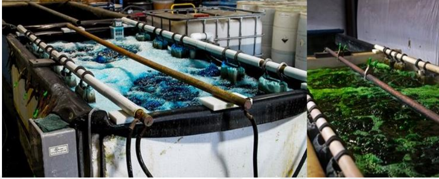
Şekil 3.7 : Krom kaplama hücreleri [38].
