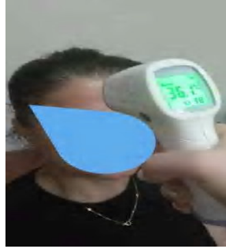
Şekil 3.21. Temassız dijital termometre
