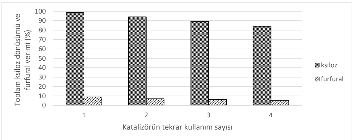
Şekil 5.70. ZnO katalizörü varlığında gerçekleştirilen katalitik işlemlerde katalizörün tekrar kullanımının ksiloz dönüşümü ve furfural verimine etkisi.
