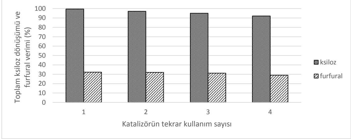
Şekil 5.69. ZrO_2 katalizörü varlığında gerçekleştirilen katalitik işlemlerde katalizörün tekrar kullanımının ksiloz dönüşümü ve furfural verimine etkisi.
