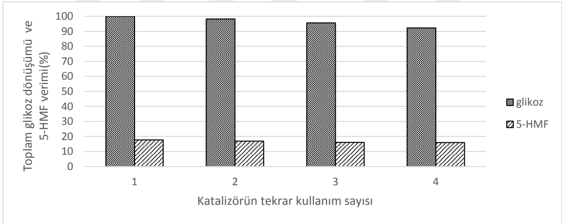
Şekil 5.68. ZnO katalizörü varlığında gerçekleştirilen katalitik işlemlerde katalizörün tekrar kullanımının glikoz dönüşümü ve 5-HMF verimine etkisi
