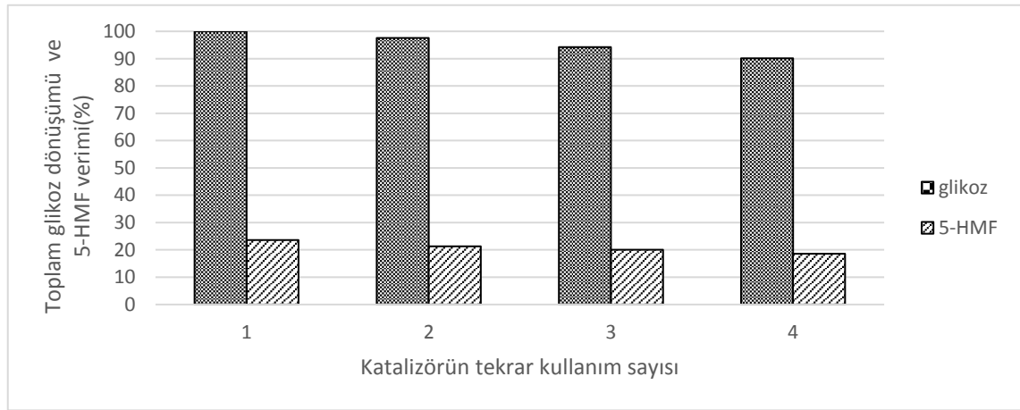
Şekil 5.66. ZrO_2 katalizörü varlığında gerçekleştirilen katalitik işlemlerde katalizörün tekrar kullanımının glikoz dönüşümü ve 5-HMF verimine etkisi.
