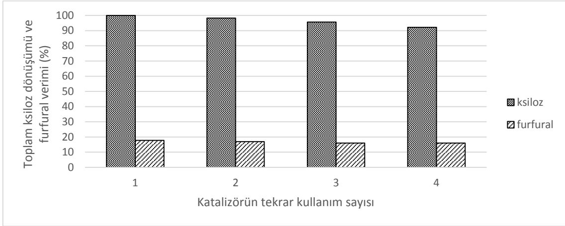
Şekil 5.71. ZnO katalizörü varlığında gerçekleştirilen katalitik işlemlerde katalizörün tekrar kullanımının ksiloz dönüşümü ve furfural verimine etkisi
