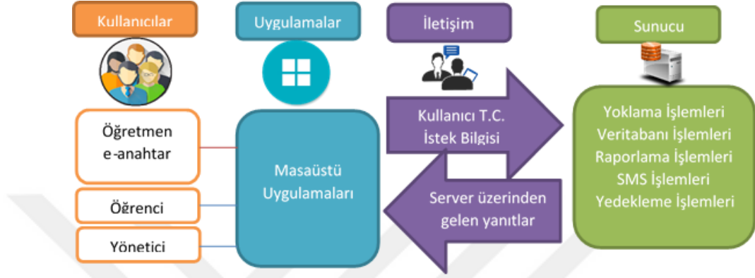
Şekil 4.1. Sistem mimarisi ve teknolojiler
