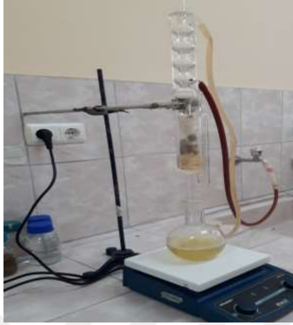
Şekil 2.1. Hambeles meyvesinin soxhlet cihazı ekstraksiyon işlemi
