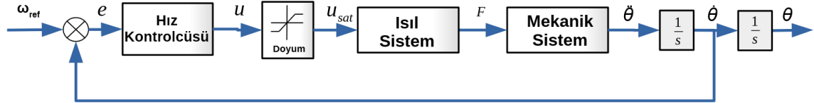
Şekil 2.15 Beta Stirling motoru kontrol diyagramı
