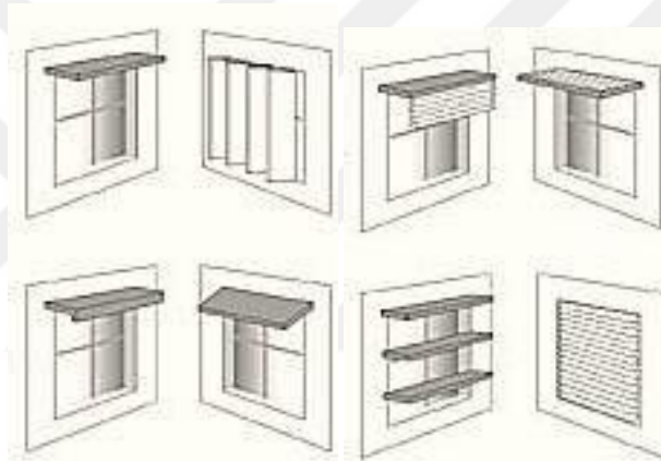
Şekil 1.9. Güneş kontrol elemanlarına örnekler
