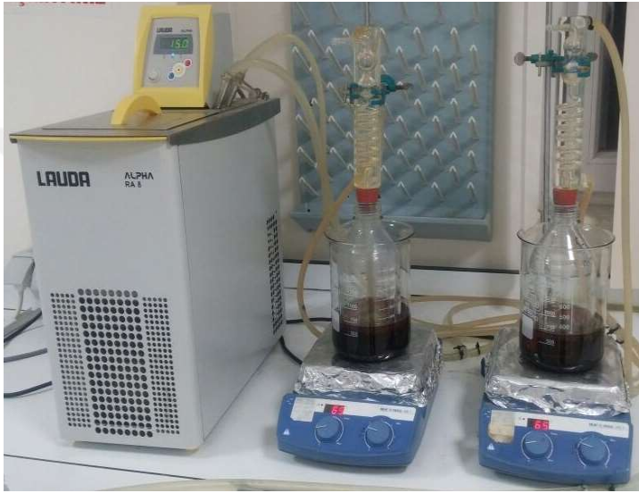
Şekil 3.2. Termal alkali H 2 O 2 ön arıtma proses düzeneği
